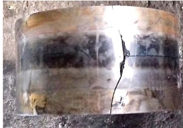
Rys. 22 Uszkodzenie walca pionowego
