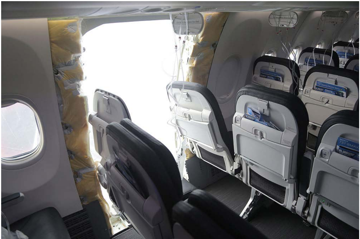
Boeing 737 Max 9 z dziurą po wyrwanym panelu. Na szczęście podczas feralnego lotu z Portland nikt nie siedział na miejscu przy oknie, a samolot jeszcze nie nabrał wysokości
