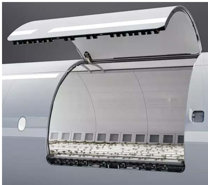
Największe w swojej klasie boczne drzwi ładunkowe XL-MDCD (Main Deck Cargo Door) o szerokości 4191 mm
