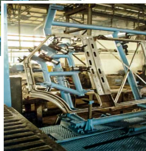
powyżej: Fragment przyrządu głównego samochodu Lublin w stanie zamkniętym
