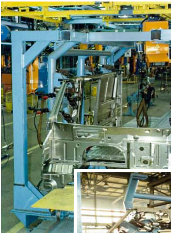
powyżej: Fragment przyrządu głównego samochodu Lublin w stanie zamkniętym
