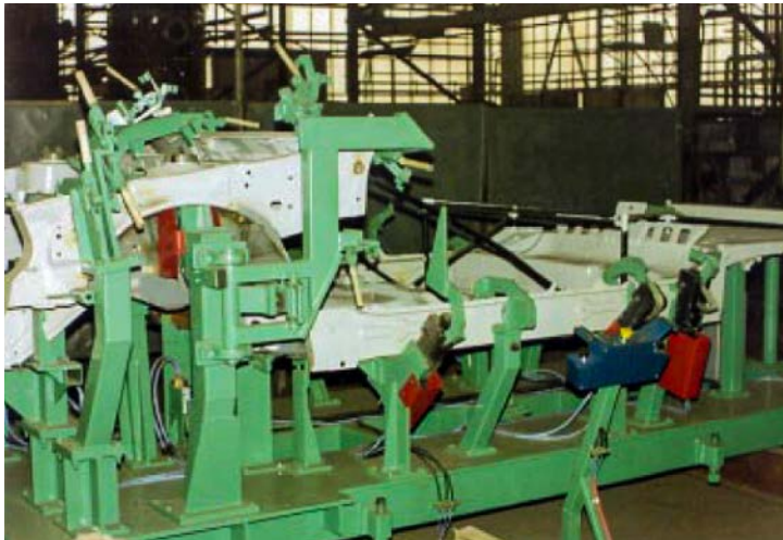
Przyrząd do zgrzewania podłogi samochodu Peugeot 309 w trakcie budowy
