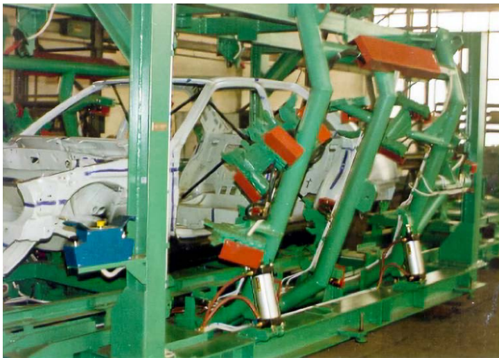
Przyrząd główny montażu spawalniczego nadwozia Peugeot 309 dla fabryki w Indiach, z napędem i sterowaniem pneumatycznym. Napęd zespołów ruchomych i sterowanie pneumatyczne na układach aparatury pneumatycznej w układzie logicznym (bez sterowania elektrycznego)
