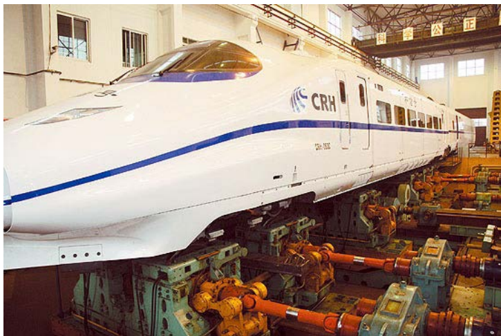
Rys. 1 Test wibracyjny wagonu pociągu przy użyciu wzbudników hydraulicznych
