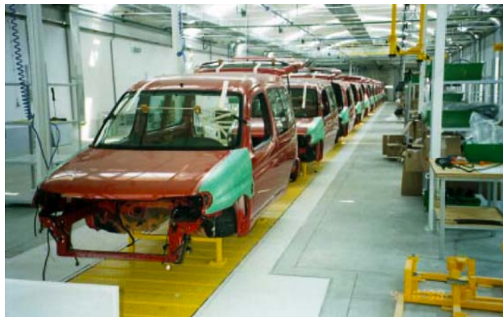
Linia montażowa Berlingo w Nysie z przenośnikiem płytowym
